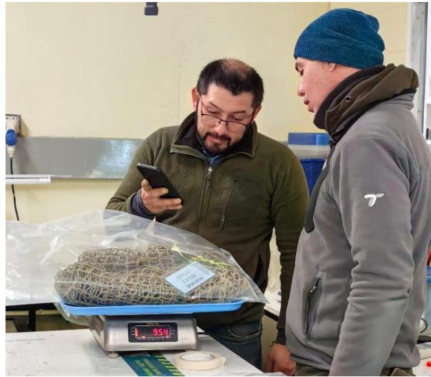
Figura 7. Registro de peso para determinación de porcentaje de humedad
